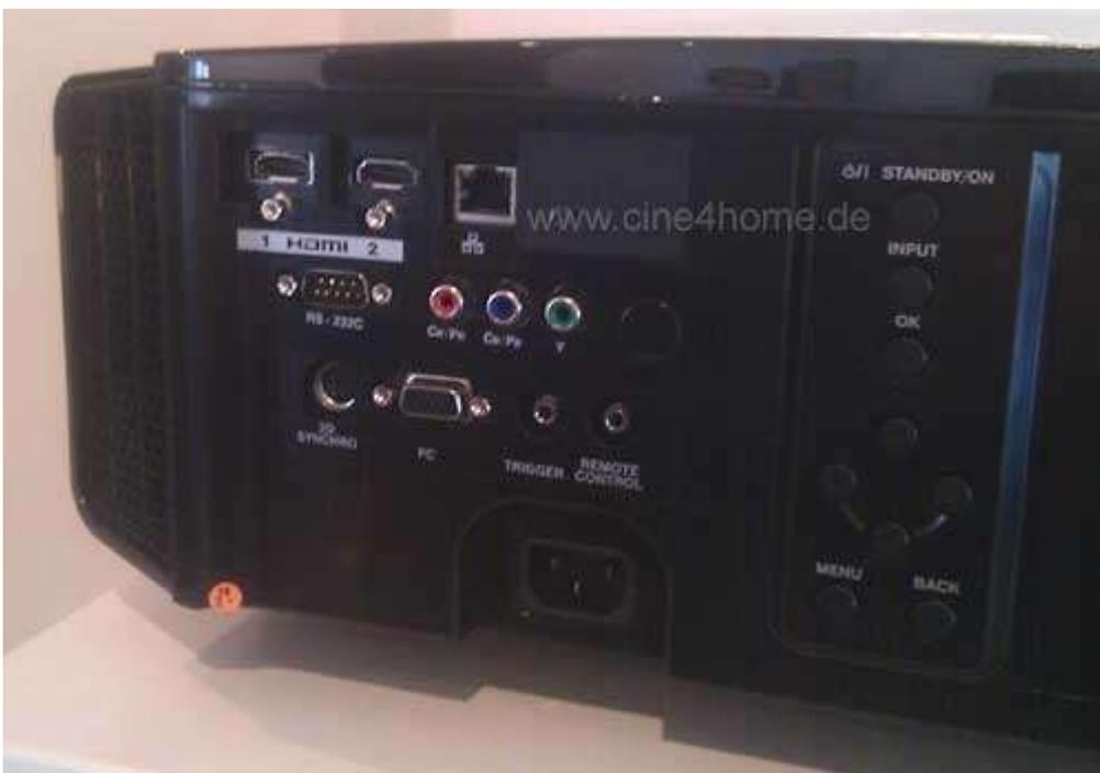
Die Anschlüsse sind ebenfalls wieder auf die Rückseite gewandert, so dass die Kabel eleganter versteckt werden können. Nicht beibehalten hat man leider den U-förmigen Kühlweg, die Luft wird nun an der Hinterseite angesaugt, so dass ausreichende Abstände zur Rückwand eingehalten werden müssen.
